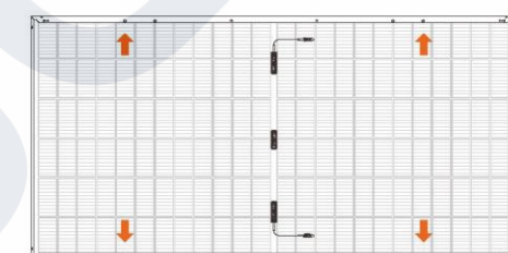
Vnější čtyřotvorová montáž šroubem, nosník kolmý ke krátkému rámu
