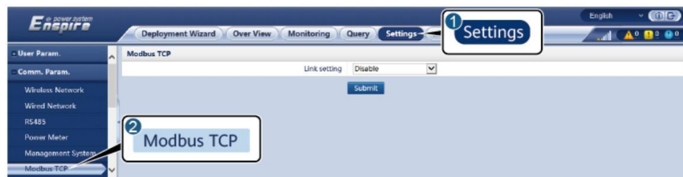
Obrázek 6-11 Nastavení parametrů Modbus TCP
