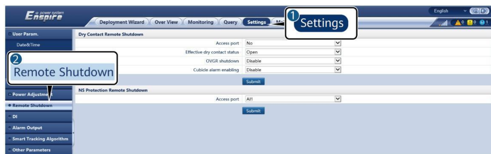
Obrázek 6-63 Dálkové vypnutí suchým kontaktem
