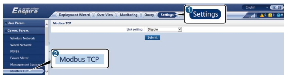
Obrázek 6-14 Nastavení parametrů Modbus TCP
