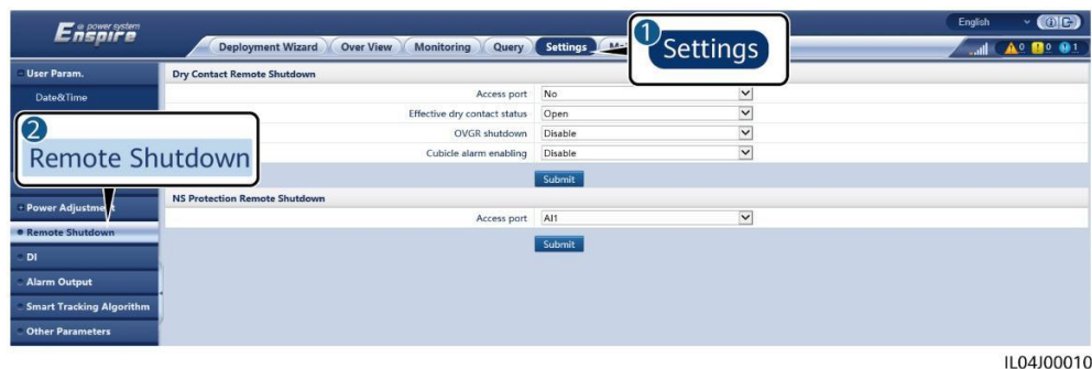
Obrázek 6-65 Vzdálené vypnutí ochrany NS
