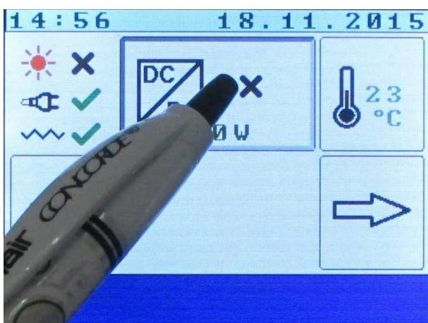
Stiskem ikony DC/DC měniče se otevře obrazovka MĚNIČ.
