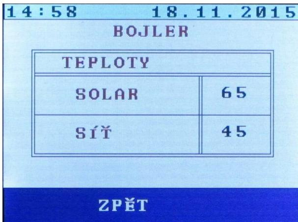
Obrazovka BOJLER umožňuje nastavení termostatů pro ohřev vody jednotlivými zdroji energie - SOLAR pro ohřev energií z FV panelů - doporučuje se nastavit co nejvýše pro využití maxima solární energie pro ohřev vody a SÍŤ pro ohřev energií ze sítě - doporučuje se nastavit co nejníže, pouze aby byla v bojleru vždy zásoba TUV (při dlouhotrvající nepřízní počasí je vhodné ji zvýšit).
