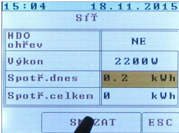
Vynulování provedeme zmáčknutím tlačítka SMAZAT, případně lze smazání odmítnout stiskem ESC.
