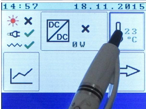
Obrazovka MĚNIČ zobrazuje údaje o stavu DC/DC měniče - vstupní napětí, výstupní napětí, výstupní proud, výstupní výkon, teplota uvnitř jednotky.
