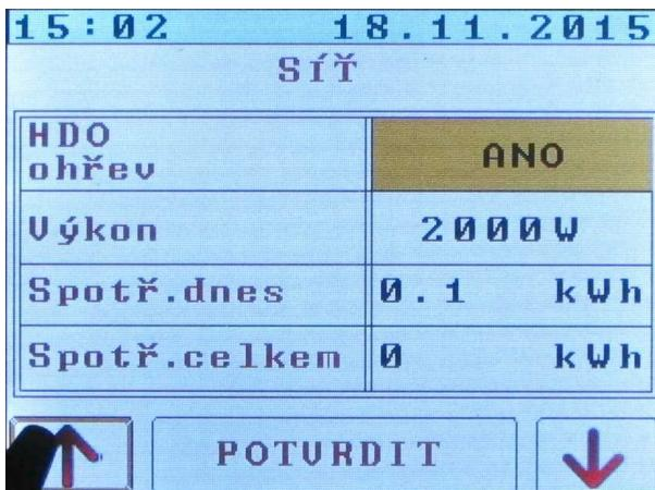
Obrazovka SÍŤ umožňuje nastavení využití sítové energie pouze v nízkém tarifu nebo nezávisle na tarifu. Rovněž také zobrazuje informace o spotřebované energii ze sítě (denní a celková spotřeba). Tato hodnota je kalkulovaná z nastavené hodnoty výkonu topného tělesa, nejedná se tedy o měření.
