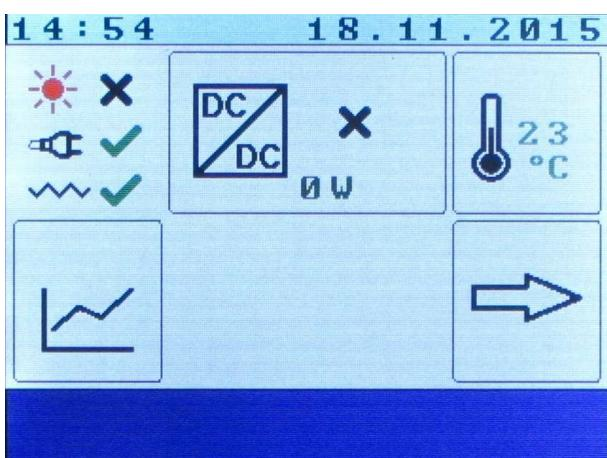
Základní obrazovka je rozdělena do několika oblastí. Jejich stiskem lze aktivovat informační obrazovku měniče (symbol DC/DC), menu pro nastavení teploty vody v bojleru (obrázek teploměru), historii spotřeby energie (tlačítko se symbolem grafu), menu externího/nabíjecího výstupu - jen u verze 315.C (ikona s obrázkem baterie) nebo lze jít na výběr dalších voleb
