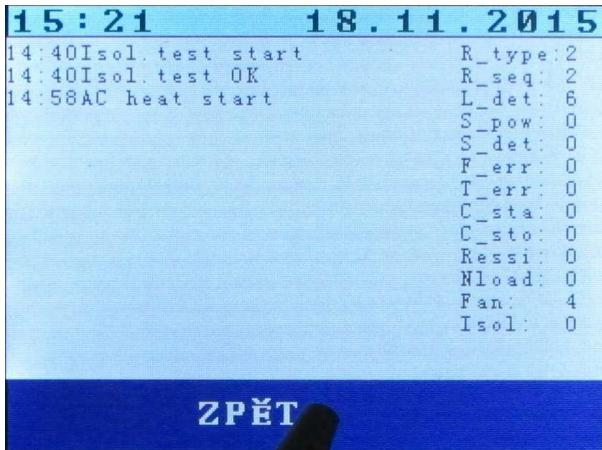
V levé části obrazovky vidíme zkratkovitě vypsané poslední události. Pravá část obsahuje výpis vnitřních stavů zařízení. Zobrazení těchto údajů může být užitečné při řešení případných problémů.
