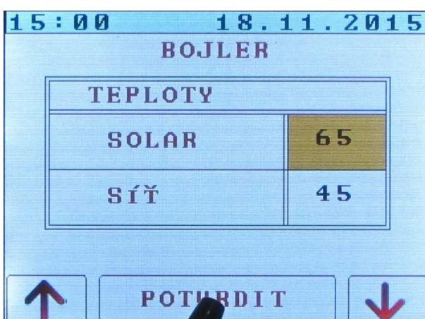
Nastavenou hodnotu potvrďte klávesou POTVRDIT. Teplotu ohřevu ze sítě (SÍŤ) nastavujeme stejným způsobem.
