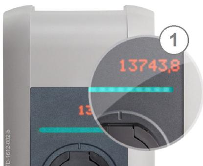
Volitelný maticový displej (1) může podle provozního stavu zobrazovat různé informace (např. verzi softwaru, stav elektroměru).
