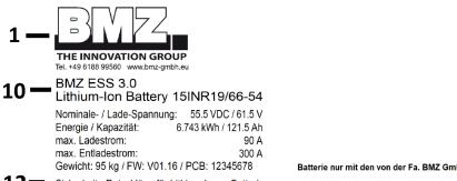
Batterie nur mit den von der Fa. BMZ GmbH freigegebenen Wechselrichtern benutzen!
