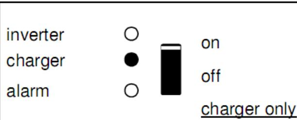
Vstupní střídavé napětí připojeno a nabíječka pracuje v režimu rychlého nabíjení nebo režimu absorpce.
