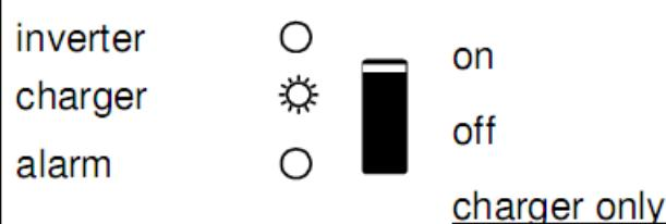
Vstupní střídavé napětí spřipojeno a nabíječka pracuje v udržovacím režimu .
