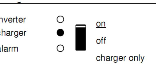
Vstupní střídavé napětí je připojeno a regulátor pracuje v režimu rychlého nabíjení nebo režimu absorpce.
