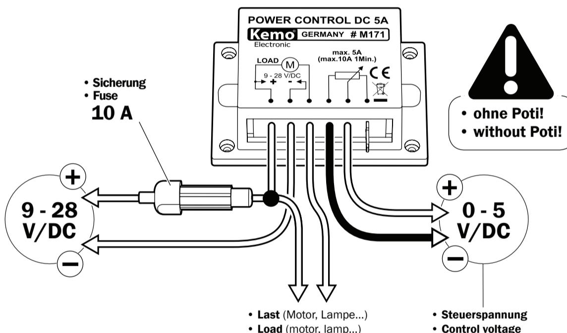
**D** | Wichtig! Die Alu-Grundplatte darf keinen mechanischen Spannungen ausgesetzt werden (keine Löcher bohren, nicht auf unebene Kühlfläche schrauben usw.). Auf der Innenseite der Alu-Grundplatte sind direkt anliegend empfindliche elektronische Bauteile montiert, die bei mechanischen Bewegungen defekt werden und das Modul dann nicht mehr arbeitet!
