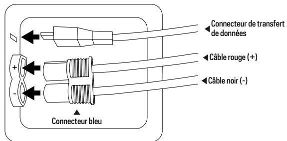
3. Prenez note des bornes positive et négative sur le port du Yeti, ainsi que sur le connecteur bleu. Insérez le connecteur bleu du module dans le port du module du Yeti Lithium, en faisant correspondre les bornes positive avec positive et négative avec négative.
