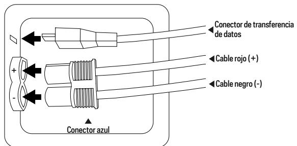
3. Observe los terminales positivo y negativo en el puerto del Yeti, así como en el conector azul. Inserte el conector del módulo azul en el puerto del módulo del Yeti Lithium, uniendo el positivo con el positivo y el negativo con el negativo.
