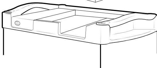
2. Öffnen Sie die Klappe des Yeti Lithium und entfernen Sie das Erweiterungsmodulgestell des Yeti, indem Sie die sechs Schrauben entfernen und das Gestell herausziehen.
