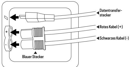
3. Beachten Sie die den Plus- und Negativpol am Anschluss des Yeti und an dem blauen Stecker. Schieben Sie den blauen Modulstecker in den Modulanschluss des Yeti Lithium, wobei positiv zu positiv und negativ zu negativ passen muss.
