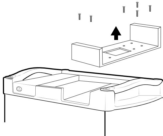
2. Abra la tapa del Yeti Lithium y extraiga el carro del módulo de expansión del Yeti retirando los seis tornillos y deslizando hacia afuera el carro.
